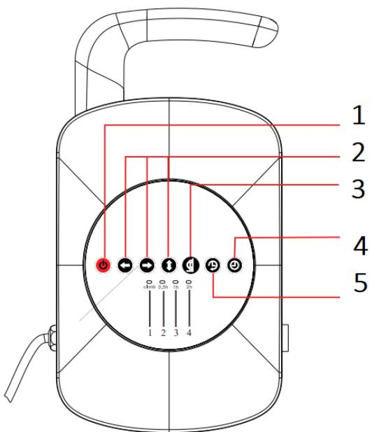
1. Кнопка питания: Включение и выключение робота
